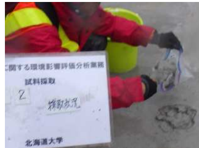
攪乱試料の採取(小湯沼)
