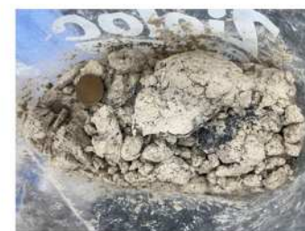
砂・礫混じり粘土状
