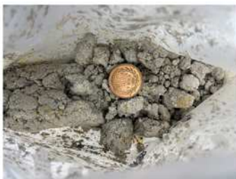
砂・礫混じり粘土状
