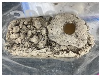
砂・礫混じり粘土状
