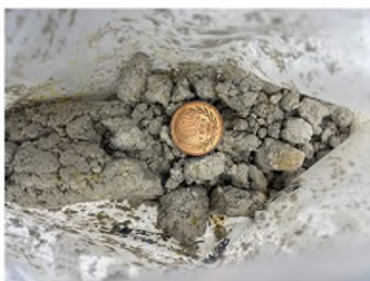
砂・礫混じり粘土状
