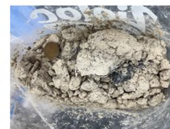
砂・礫混じり粘土状
