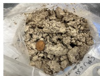
砂・粘土混じり礫状
