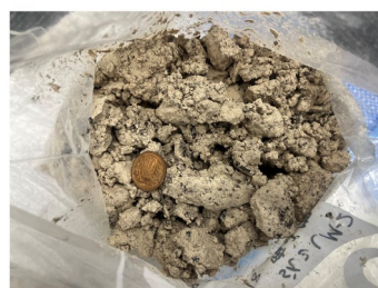
砂・粘土混じり礫状
