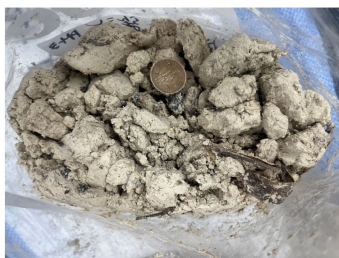
砂・礫混じり粘土状
