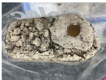
砂・礫混じり粘土状
