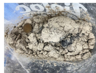
砂・礫混じり粘土状
